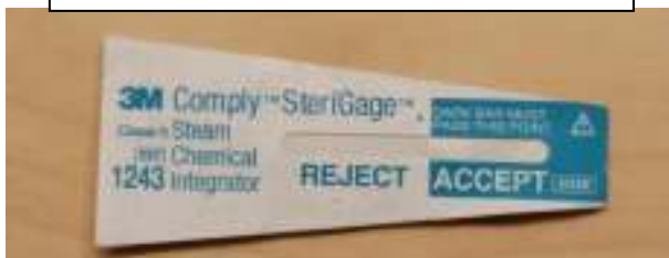
Control integrador no virado
